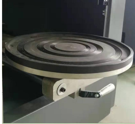
可前移的下夹盘 使装卸包装桶变得轻松方便
