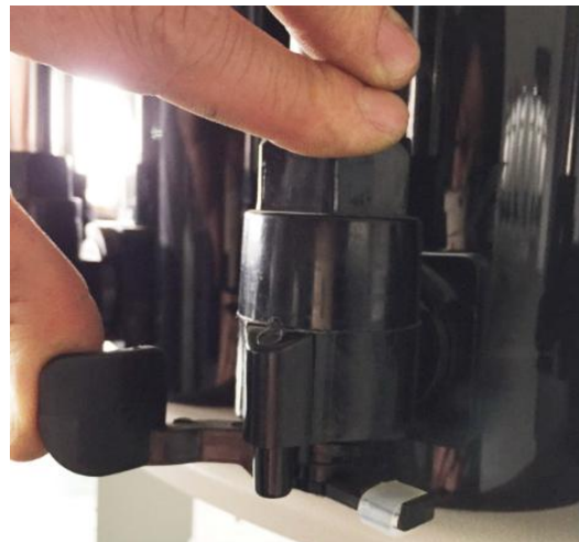
密封阀手柄内置扭簧，可自动关闭出料嘴，防止色浆干枯。
