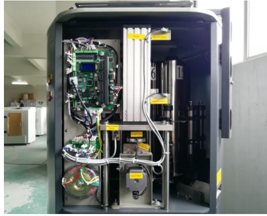
前置主板和电气结构，方便维修
